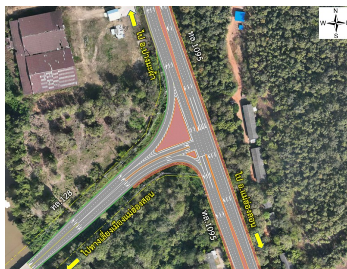
รูปที่ 8.1-9 รูปแบบการปรับปรุงทางแยก ทล.1095 ตัดกับ ทล.128 (แยกทางเลี้ยวเมืองแม่ฮ่องสอน) ติดตั้งสัญญาณไฟจราจร
