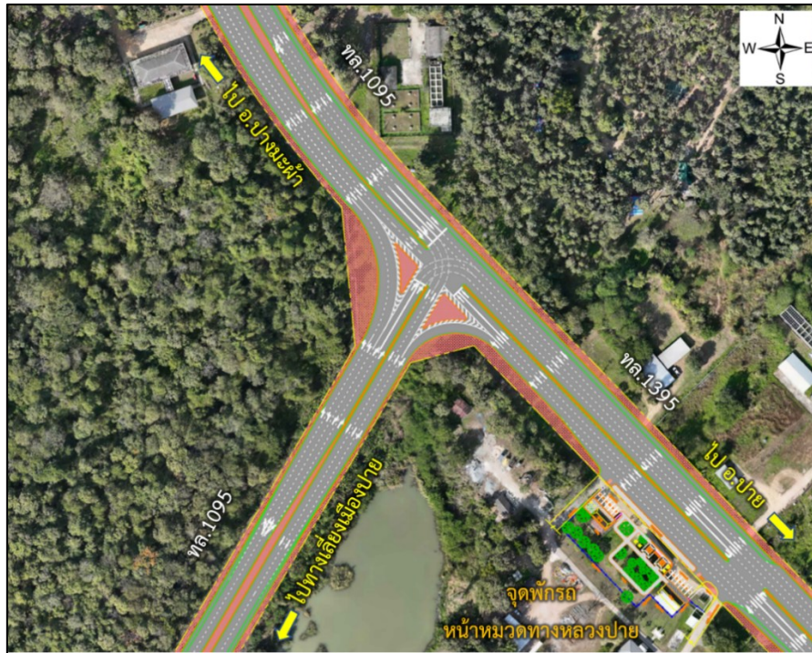
รูปที่ 8.1-6 รูปแบบการปรับปรุงทางแยก ทล.1095 ตัดกับ ทล.1395 (แยกทางเลี้ยวเมืองปาย ค่ายทหารโสมบัณฑิตย์) ติดตั้งสัญญาณไฟจราจร
