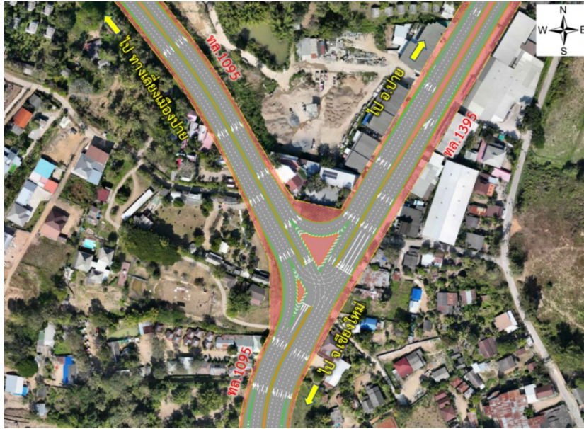
รูปที่ 8.1-3 รูปแบบการปรับปรุงทางแยก ทล.1095 ตัดกับ ทล.1395 (แยกทางเลี้ยวเมืองปาย) ติดตั้งสัญญาณไฟจราจร
