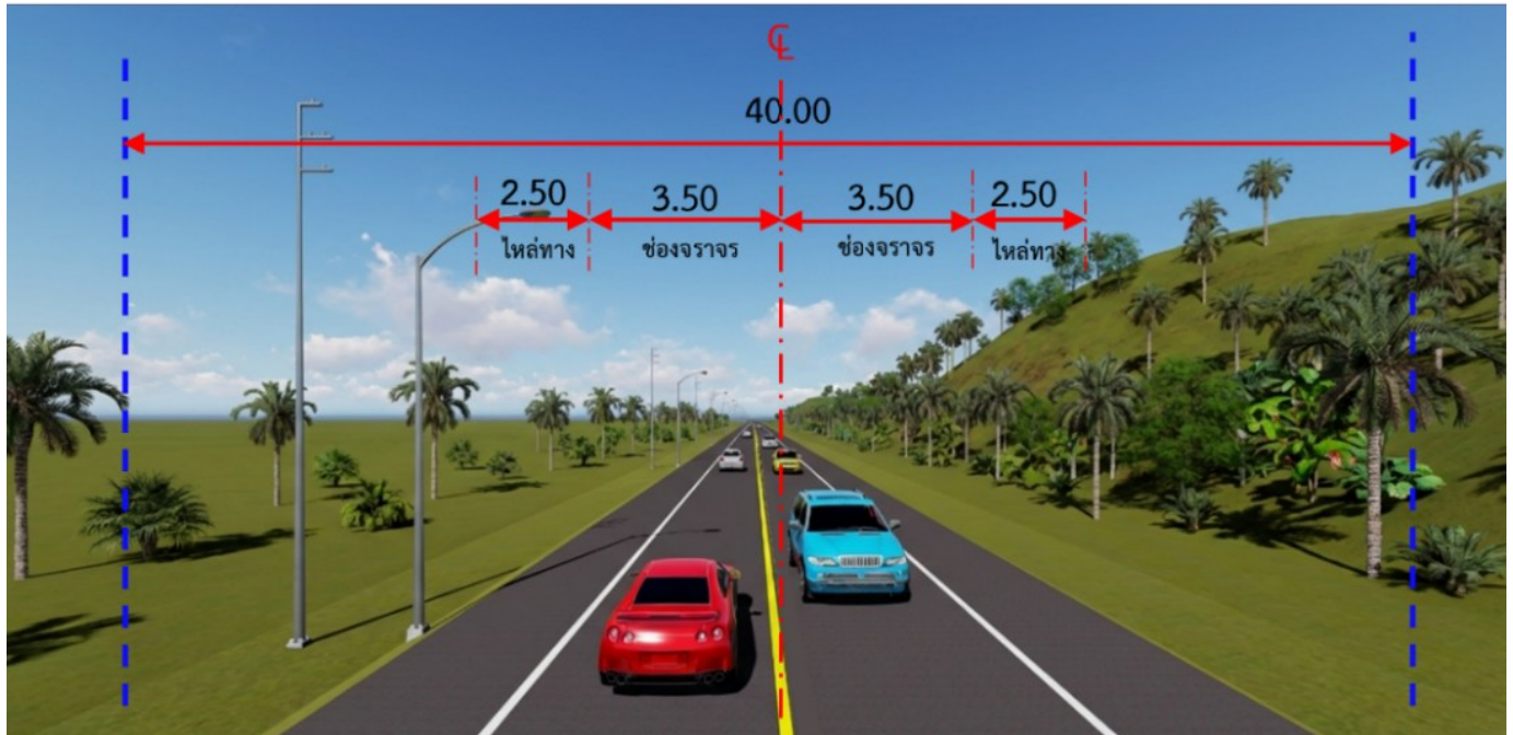
รูปที่ 7.1-6 ทางหลวงนอกเขตชุมชน : ทางหลวง 2 ช่องจราจร เกาะกลางแบบทาสีตีเส้น (Painted Median)
