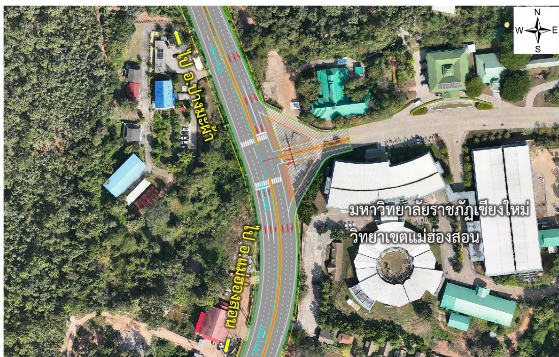
รูปที่ 8.1-11 รูปแบบการปรับปรุงทางแยกข้ามมหาวิทยาลัยราชภัฏเชียงใหม่ วิทยาเขตแม่ฮ่องสอน ติดตั้งสัญญาณไฟจราจร
