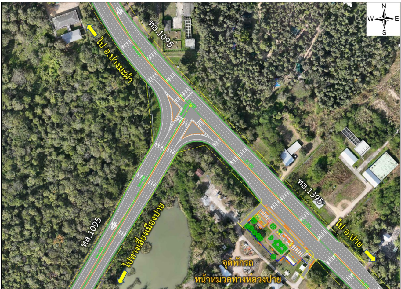
รูปที่ 8.1-6 รูปแบบการปรับปรุงทางแยก ทล.1095 ตัดกับ ทล.1395 (แยกทางเลี่ยงเมืองปาย ค่ายทหารโสมบัณฑิตย์) ติดตั้งสัญญาณไฟจราจร
