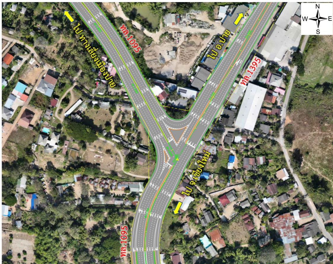
รูปที่ 8.1-3 รูปแบบการปรับปรุงทางแยก ทล.1095 ตัดกับ ทล.1395 (แยกทางเลี้ยวเมืองปาย) ติดตั้งสัญญาณไฟจราจร
