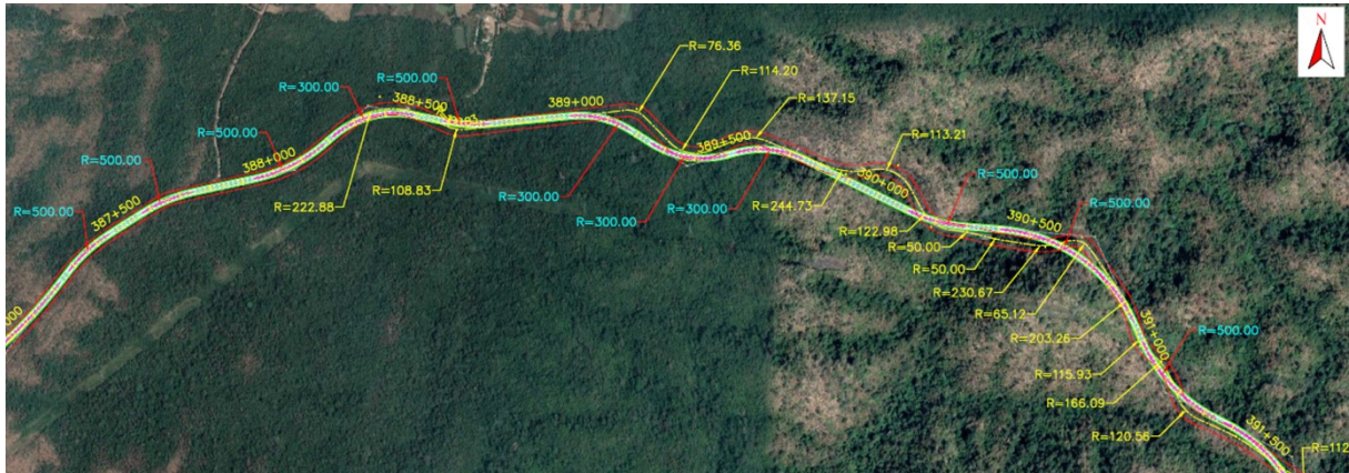
รูปที่ 8-1 แสดงภาพ 3 มิติ ตัวอย่างการปรับแนวทางราบ
