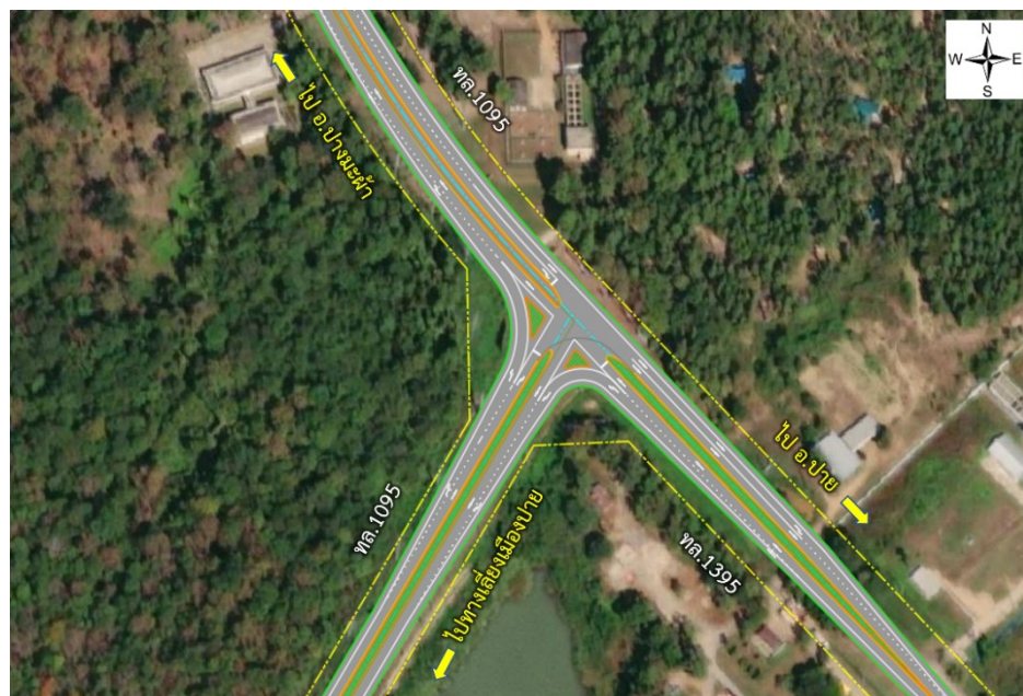
รูปที่ 8-26 รูปแบบการปรับปรุงทางแยก ทล.1095 ตัดกับ ทล.1395 ติดตั้งสัญญาณไฟจราจร
